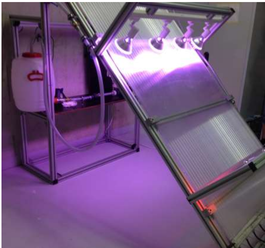
Abb. 2a: Algenreaktor mit eingeschalteten Pflanzenlampen.
