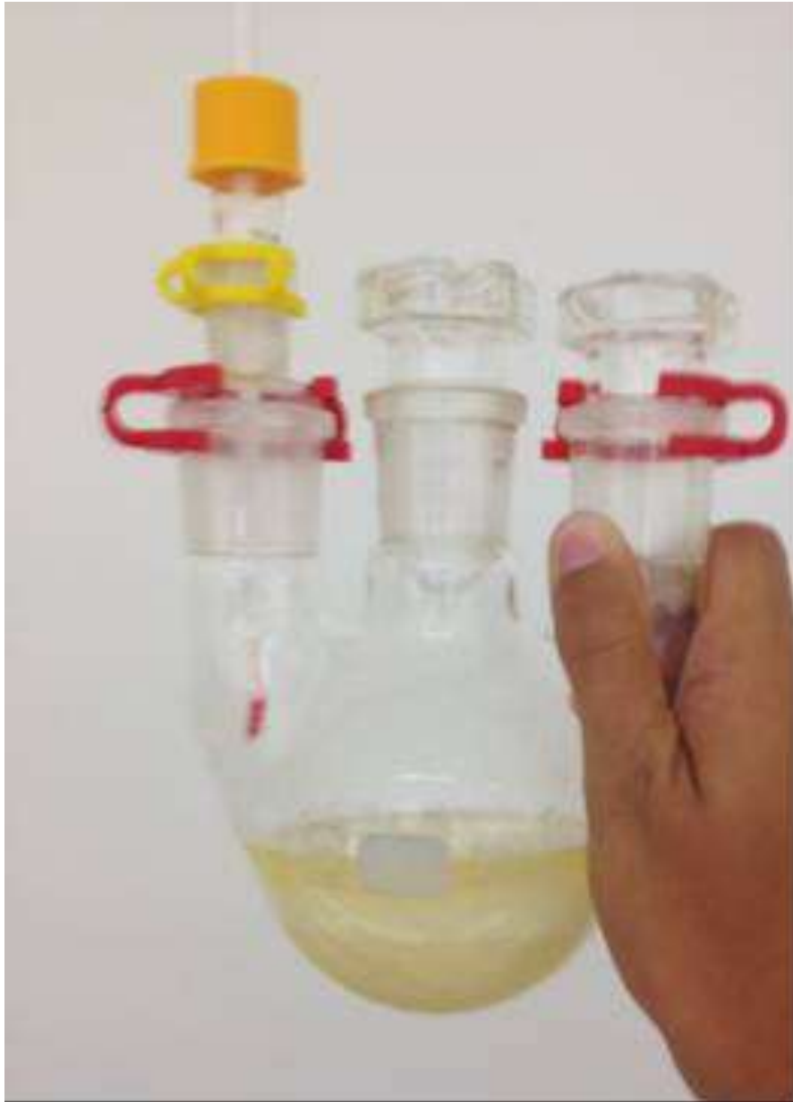
Abb. 9: Herstellung von Biodiesel aus Rapsöl: obere Phase: als Biodiesel verwendbare Ester, untere Phase: nicht brennbares Glycerin.
