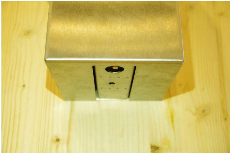
Abb. 3b: Unterseite des Seifenspenders. In der Öffnung vorne befindet sich die Spenderdüse, in der Öffnung hinten der kapazitive Sensor.
