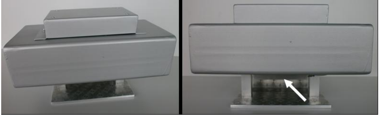
Abb. 4b: Gehäuse des Seifenspenders nach dem Spritzvorgangs. Im Bild rechts ist im Zwischenraum oben ein quaderförmiges Bauteil zu erkennen, das die Düse sowie Sensoren enthält.
