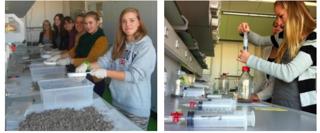
Sieben des Bodens, um den Steinanteil zu bestimmen (links) und Durchführung der Bodenrespirationsmessung (rechts).
